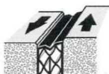
3. Компенсирует горизонтальные подвижки
